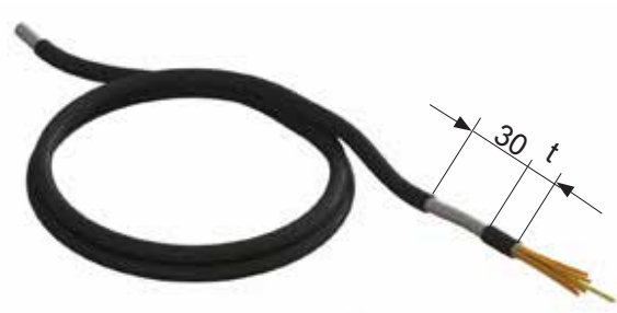
Εικ. 25 Απογυμνώστε το καλώδιο ΗΜΣ σε 30 mm πριν το συνδέσετε στη βάση ακροδεκτών. Διάσταση «t» περίπου αντίστοιχη με την απόσταση από το σφικτήριο στερέωσης στον ακροδέκτη καλωδίου
