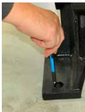
Bild 8a Bohrlöcher markieren
